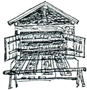
wird. Nachdem die Darren, die man zum Aufschütten heraufziehen kann, wobei sie auf einem kleinen Schrägen und auf die Unterkante der Türöffnung aufgelegt werden, gefüllt sind, schiebt man sie hinein, schließt die Tür und heizt im Ofen ein. Das Feuer wird mit grobem, knorrigem Holz, das man nicht weiter zerkleinern kann, unterhalten.
